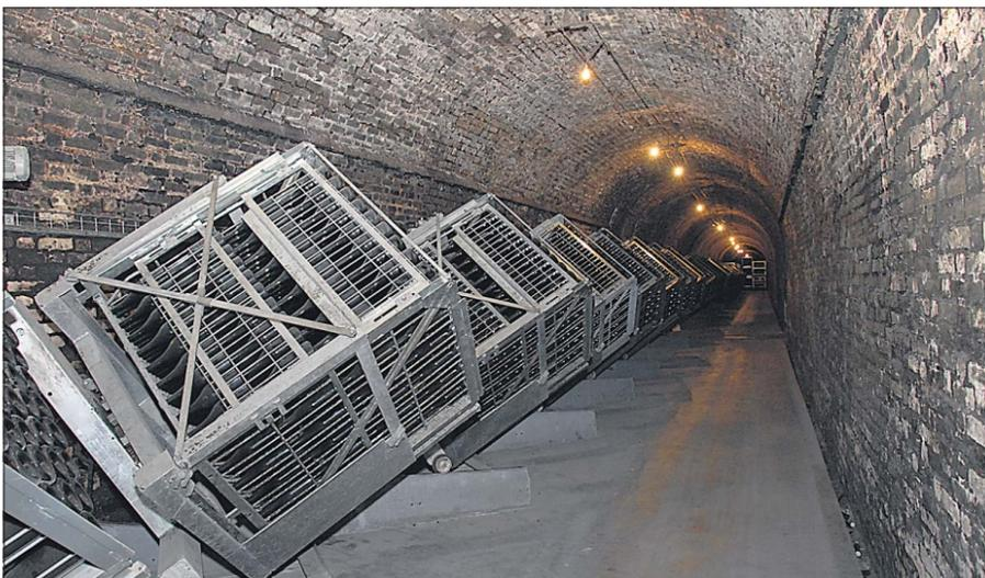
Die gefüllten Champagner-Flaschen in den würfelförmigen Drahtkäfigen (gyropalettes) werden im Keller von Robotern maschinengesteuert gedreht (remuage mécanique).
